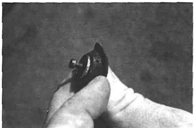
Rys. 7.14. Zużyta przepona podciśnieniowa, sterująca pracą gaźniczka wspomagającego
